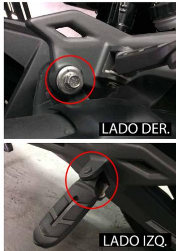
3. Instale el soporte completamente como se indica en los pasos anteriores.
