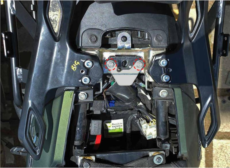
Utilizar tornillos **T7** en los puntos indicados en la imagen.
