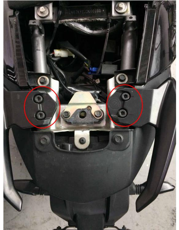
2. Vuelva a ensamblar la chapa del asiento pero elevandola con los bujes como se muestra en la imagen.
