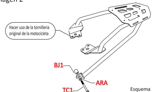
Al terminar la instalación de las partes, verifique que el soporte de maleta esté alineado y que toda la tornillería esté debidamente apretada; reajuste todos los tornillos.
