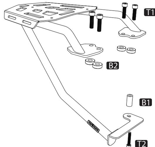
Al terminar la instalación de las partes, verifique que estén alineadas y que toda la tornillería esté debidamente apretada; reajuste todos los tornillos.
