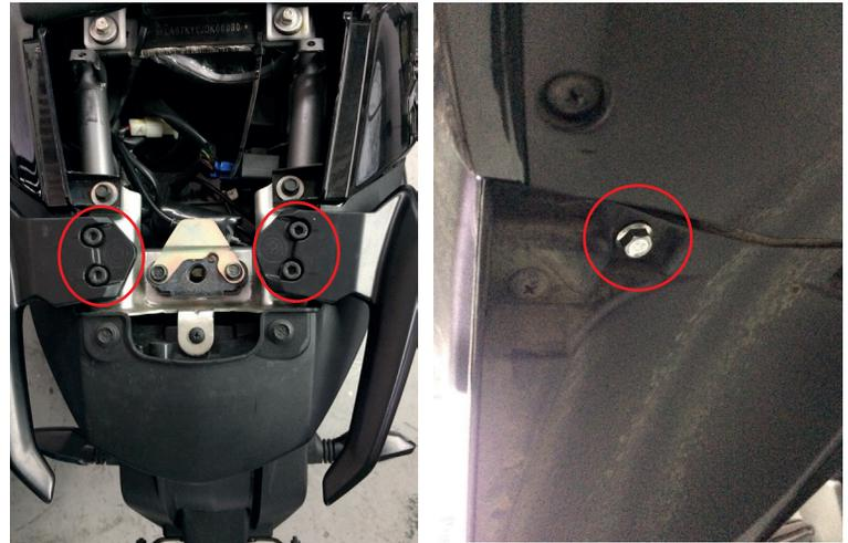
2. Instale el soporte con la tornillería incluida en el kit como lo indica el esquema.
